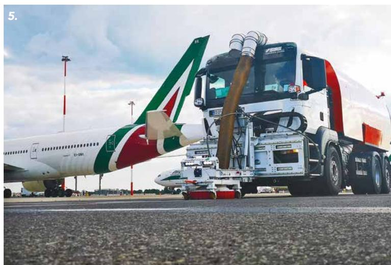
sistema brevettato in grado di ottimizzare l'utilizzo dell'acqua, SIAS riesce a rimuovere con una singola passata una fascia larga 3.400 mm ad una velocità di avanzamento di circa 1.500 m/ora; questo si traduce in una capacità di sgommatura di circa 25.000 m<sup>2</sup>, ipotizzando un turno lavorativo di 5 ore: quindi circa tre volte la produzione storicamente documentabile, con una notevole riduzione dei tempi di cantierizzazione e conseguente minor esposizione al pericolo per gli operatori.
