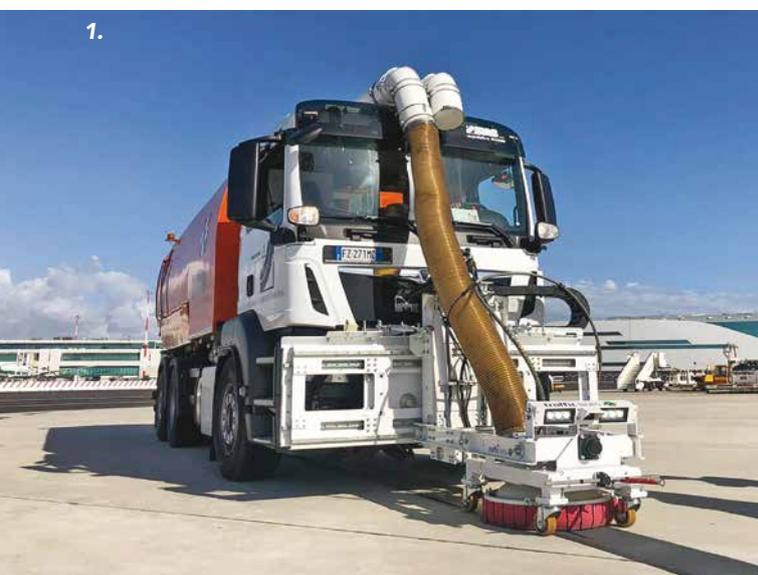
sata sull'idrodemolizione selettiva a controllo numerico (già ampiamente usata ad esempio per la demolizione di manufatti in calcestruzzo armato) in grado di effettuare la cancellatura di segnaletica orizzontale, la rigenerazione del manto stradale e la rimozione dei residui di gomma dai punti di attacco delle piste aeroportuali (sgommatura), rispettando e preservando le caratteristiche meccaniche delle superfici trattate.
